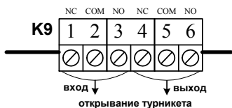
Пример 5. Подключение турникета (турникетный режим)
